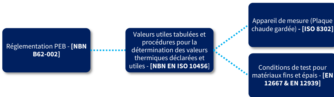
Figure 1 : Schéma de principe du cadre réglementaire pour la certification des performances hygrothermiques de matériaux d'isolation dans le bâtiment
